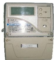
Счетчик ЦЭ6850М (Энергомера) предназначен для измерения активной и реактивной электрической энергии, активной, реактивной и полной мощности в трехфазных четырехпроводных цепях переменного тока. Является экономически оправданным вариантом для установки в ячейках КРУ 6(10) кВ.
